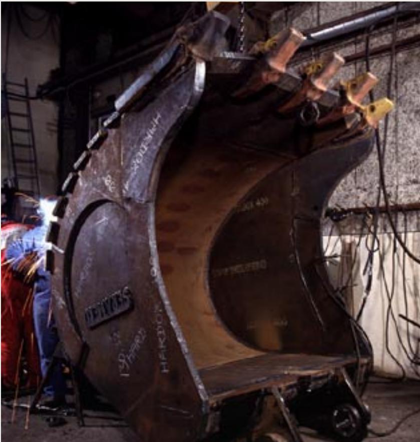
HARDOX HiTuf peut être soudé grâce à des méthodes conventionnelles.
